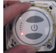
La « Led » rouge reste allumée pendant 2 secondes.
